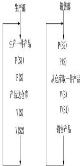
图中信号量  $S_1$  和  $S_2$  为同步信号量，初值分别为  $n$  和  $0$ ； $s$  是一个互斥信号量，初值为 (9)。
